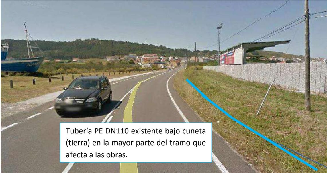
Tubería PE DN110 existente bajo cuneta (tierra) en la mayor parte del tramo que afecta a las obras.
